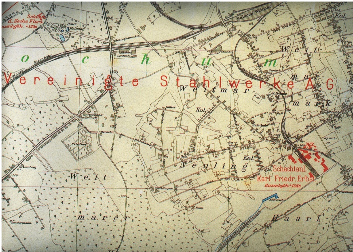
Ausschnitt aus dem Situationsplan der Zeche Carl Friedrich Erbstollen, angefertigt von dem Markscheider G.Schulte, Karte Bochum Nr.31 mit Bochum-Weitmar- Neuling, bearb. 1929. (Quelle: RP Arnsberg, Abtlg. Bergbau u.Energie in NRW) WS = Wetterschacht = Schacht 2 gegenüber Schacht 1 am Anfang der heutigen Kemnader Str..
